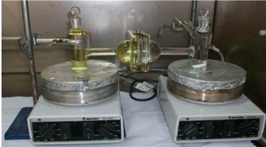
Figura 3-19: Foto del dispositivo diseñado para medir permeabilidad/migración, al momento inicial de la experiencia.
