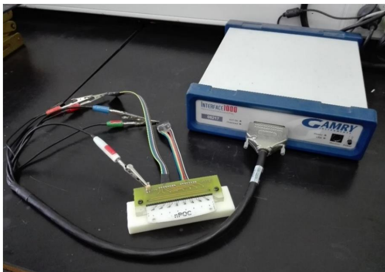
Figura 2.3- Potenciostato Gamry , celdas electroquímicas y conectores utilizados para llevar a cabo las medidas electroquímicas
