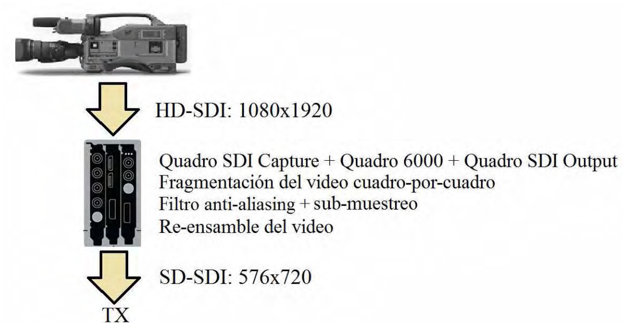
Figura 3.11: Codificador implementado con GPGPUs.
