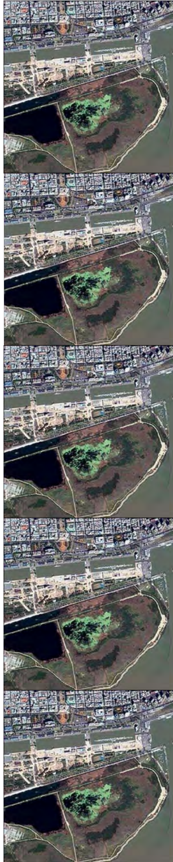
Figura 4.6: Primero (arriba) imagen original, segundo (codificado y decodificado con JPEG), tercero (codificado y decodificado con JPEG+Supercompresión), cuarto (codificado y decodificado con JPEG2000), quinto (abajo, codificado y decodificado con JPEG2000+Supercompresión).
