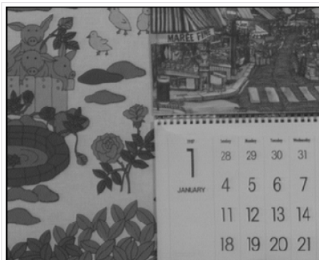
Figura 2.9: Cuadro (frame) obtenido a partir del proceso de super-resolución, consistente en generar un cuadro más nítido a partir de la combinación de los cuadros disponibles de la escena
