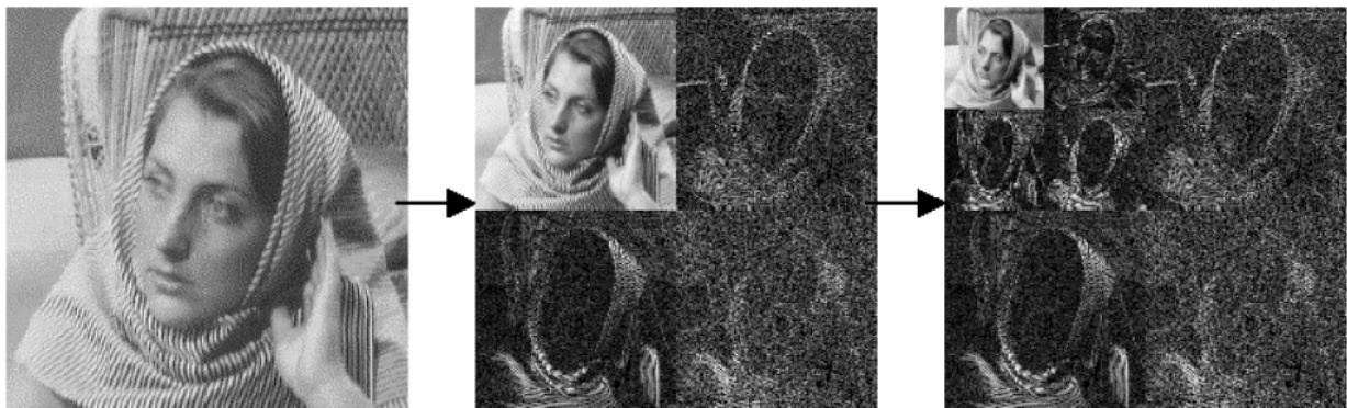
Figura B.15: Transformada de onditas: efecto del filtrado en frecuencia sobre una imagen en escala de grises.
