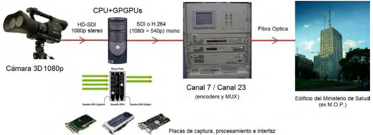
Figura 3.23: Captura, super-compresión, codificación, multiplexado y transmisión.
