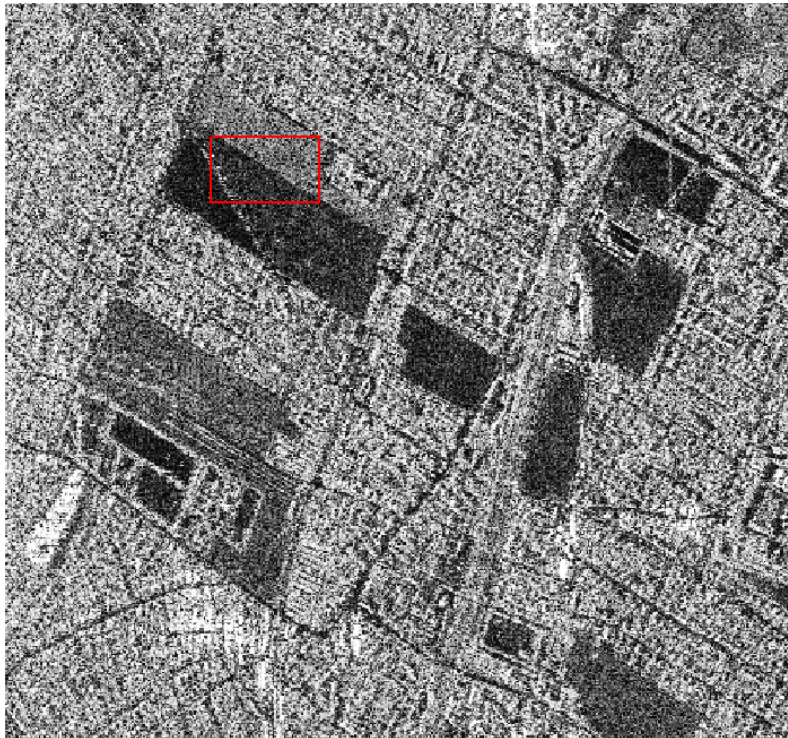
Figura 7.5: Imagen SAR y área seleccionada para el estudio de detección de puntos de borde
