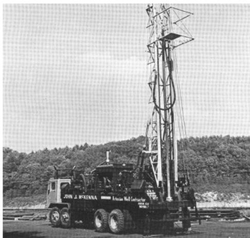
Equipo de perforación por rotoperforación. En la imagen se aprecia el compresor para operar el martillo neumático y extraer el material triturado por el trépano. También posee una bomba de inyección de lodo.
