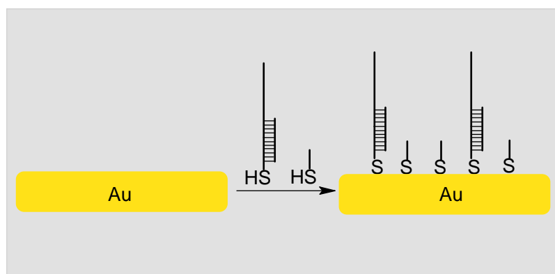
Figura 4.7 Esquema de la modificación del Au con ADN doble hebra
