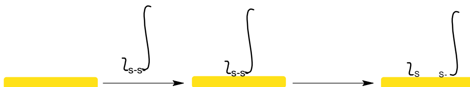
Esquema A: exposición directa a la hebra de ADN modificada con un grupo disulfuro (-S-S-)
