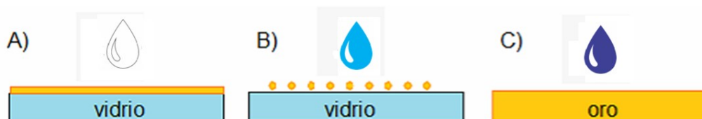
Figura 4.11: A) Oro depositado sobre vidrio por evaporación. B) Nanopartículas de oro depositadas sobre vidrio. C) Lámina de oro policristalino. El color de las gotas representa la intensidad del color del producto de la reacción.
