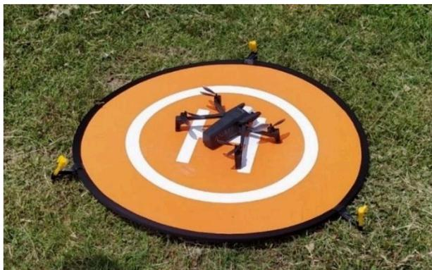
Se realizó un vuelo autónomo planificado a través de la aplicación Pix4D capture, estableciendo los siguientes parámetros: altura de vuelo de 70 m, velocidad crucero de 8 m/s, traslape longitudinal y transversal del 80 %. Como resultado se obtuvieron 172 imágenes (formato JPG) con 2,72 cm/pix de resolución espacial.
