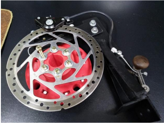
Fig 17. Construcción de Freno de Prony para medir torque.
