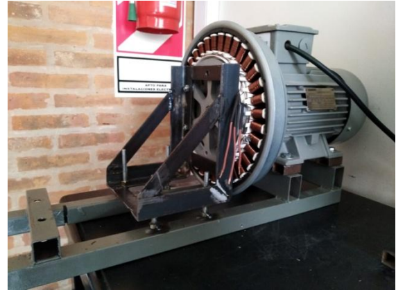
Fig. 16. Instalación del motor brushless en el banco de ensayos.
