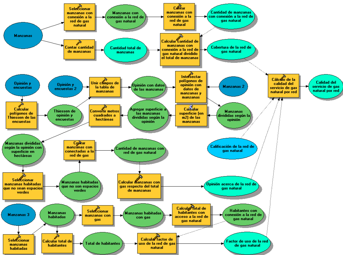
Figura 2. Modelo para calcular la calidad del servicio de gas natural por red.
