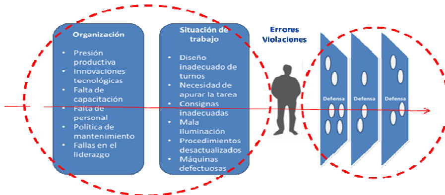
Figura 1. Detección de fallas latentes
