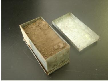
**Figura 2.4:** Cajas de Kubiena utilizadas para la obtención de muestras de suelo sin disturbar.
