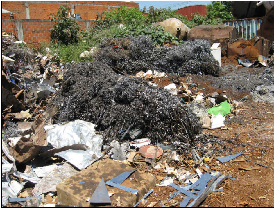
Foto N° 3: Viruta de hierro, se observa óxido de hierro en contacto con el suelo. Prensadora de Zona Noroeste de RMBA. Fuente: Relevamiento de campo (2007).
