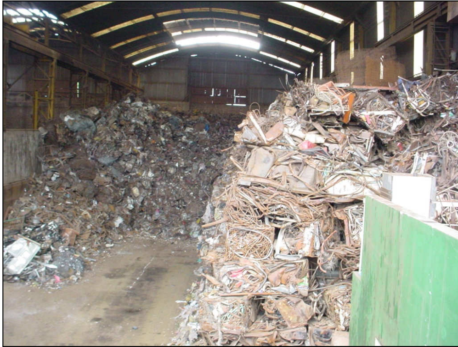
Foto N° 13: Pila de chatarra enfardada (adelante) y lista para enfardar (atrás). Prensadora del Partido de Avellaneda. Fuente: Castillo, M. (2005)
