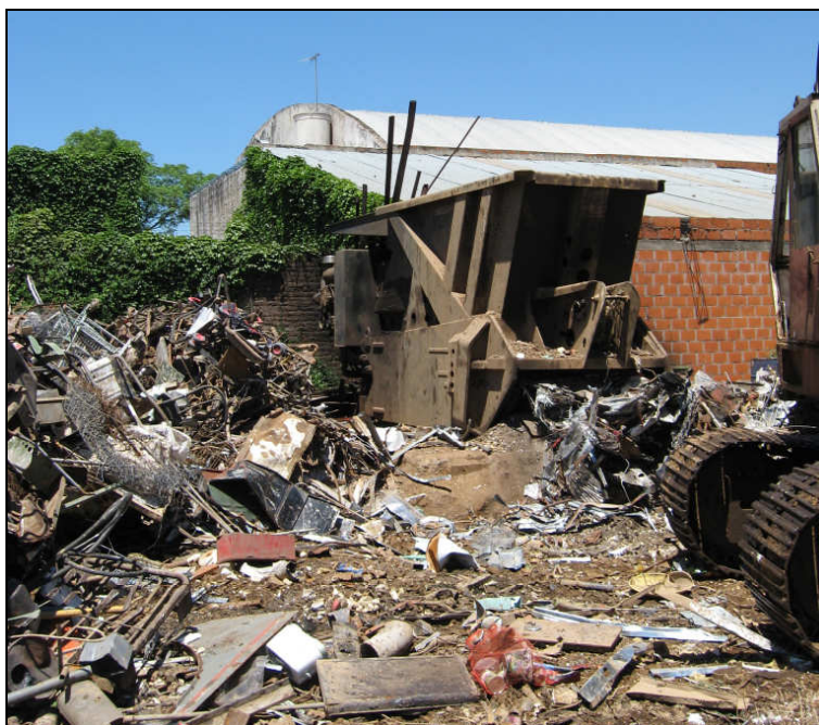
Foto N°22: Cizalla Horizontal Descargable Fuente: Relevamiento de campo (2007)
