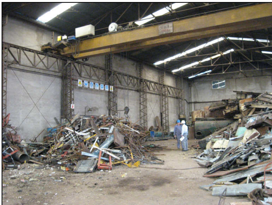
Foto N° 11: Puente Grúa utilizado para manipular materiales dentro del depósito Prensadora de Zona Noroeste de RMBA. Fuente: Relevamiento de campo (2007)
