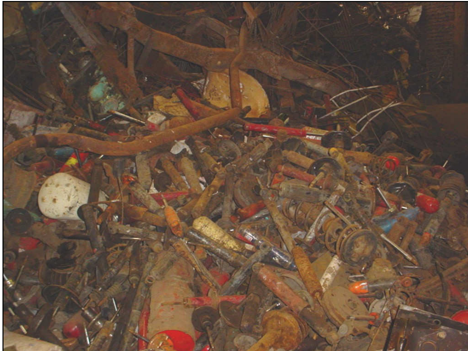
Foto N° 25: Amortiguadores separados del resto de la chatarra, no aptos para la venta a las acerías por su propiedad de ser explosivos. Fuente: Castillo, M. (2005)
