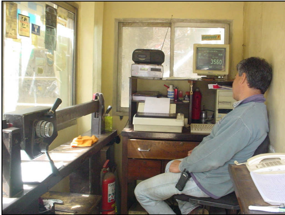
Foto N° 17: Sala de control de balanza electrónica, a la izquierda se observa una balanza manual. Prensadora del Partido de Avellaneda. Fuente: Castillo, M. (2005)
