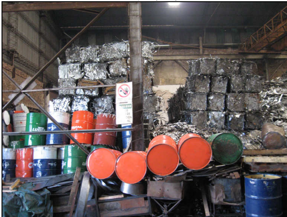
Foto N° 14: Hierro “nuevo” enfardado, procesado en prensa convencional. Prensadora del Partido de Gral San Martín. Fuente: Relevamiento de campo (2007)
