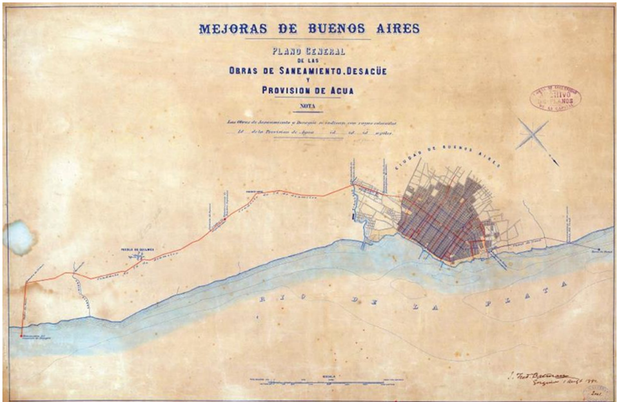
Figura 4.8: Esquema del Plan Radio Antiguo de saneamiento de Buenos Aires. 1882
