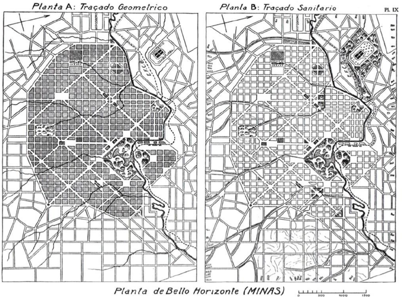
Figura 2.15: Proyecto de Belo Horizonte en la Planta A diseñado por Aarão Kings y la Planta B el trazado propuesto por Brito a la ortogonalidad que omite topografía y cursos de agua. c.1915
