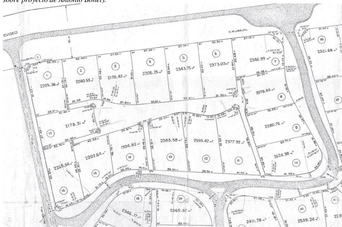
*Nota: Se aprecia la división de las grandes manzanas en predios de no menos de 2000 m<sup>2</sup>. Además del trazado de solares, y afectaciones, el plano incluye las siguientes especificaciones para la urbanización: "Pavimento: hormigón coloreado. Senderos: losas con césped. desagües cloacales colocados en la red de senderos. Aguas corrientes junto a las pistas de vehículos. Energía eléctrica y teléfonos subterráneos"*
