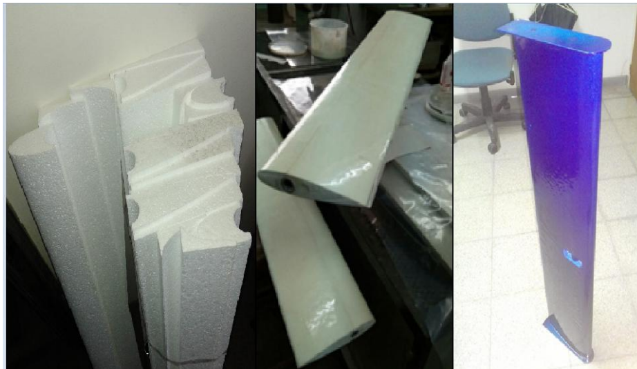
Figura 2: Proceso de fabricación de palas.
