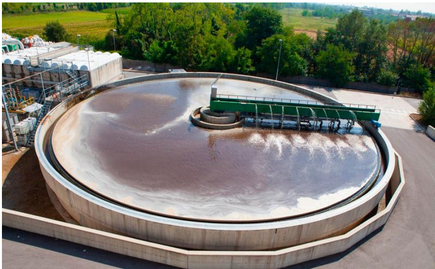
Figura 5. Instalaciones donde se lleva a cabo la precipitación química: Ésta técnica se basa en la precipitación de los iones metálicos en forma de hidróxidos (Imagen extraída de https://www.ceupe.com/blog/que-es-la-precipitacion-quimica.html ).
