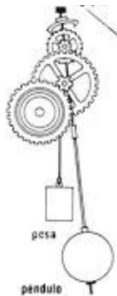
Figura 3.3: Péndulo accionado por una pesa.
